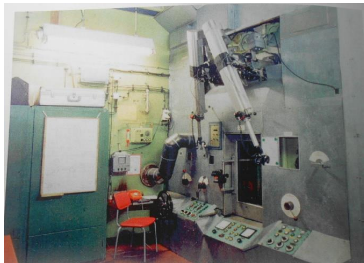
Foto des Arbeitsplatzes der Heissen Zelle im Operator-Raum des KKW Rheinsberg, aus der Dokumentation der EWN
